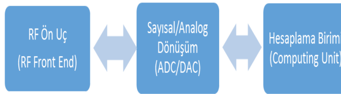
Şekil 1: Yazılım Tanımlı Radyo Genel Yapısı
